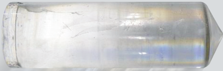
○ 碘化铯晶体毛坯 \Phi 90 \times 300 mm
